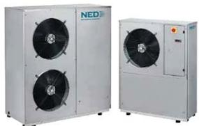
Чиллеры и тепловые насосы с воздушным охлаждением конденсатора, с осевыми вентиляторами, с накопительным баком и насосом, со спиральными компрессорами производительностью от 4,2 до 20,5 кВт, наружного исполнения. Изготавливаются в 10 типоразмерах. Используемый хладагент: R410A.
