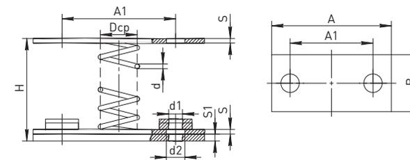
Линейка представлена 7 типоразмерами. Виброизоляторы необходимы для снижения динамической нагрузки, передаваемой от вентилятора на несущую конструкцию.
