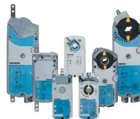
Приводы предназначены для управления воздушными заслонками в системах вентиляции и кондиционирования воздуха. Прочный алюминиевый или пластиковый корпус обеспечивает большой срок службы привода. Необслуживаемая бесшумная зубчатая передача с защитой от расщепления и перегрузки на весь срок эксплуатации. Приводы защищены от перегрузок, остановка происходит автоматически при достижении конечных положений.
