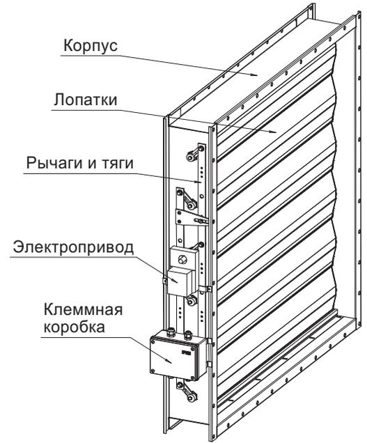
Клапан КОРД-1 с электроприводом взрывозащищённый
