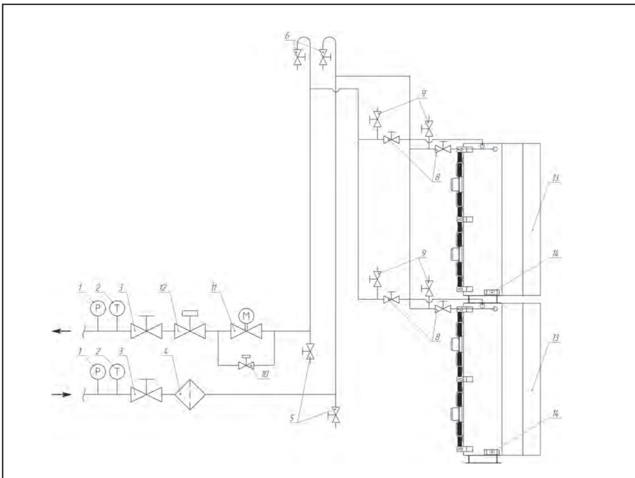
1 – Манометр. 2 – Термометр. 3 – Шаровый кран для отсечения подачи теплоносителя на завесы. 4 – Фильтр грубой очистки. 5 – Шаровый кран для слива воды из магистрали. 6 – Шаровый кран для выпуска воздуха из магистрали.
